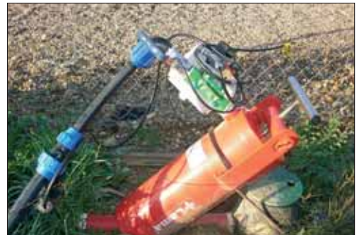
3.10: se hace pasar al agua de riego por el tanque que tiene el fertilizante disuelto. Antes de distribirse, pasa por un filtro por si pudiera tener algún elemento que nos obstruya las boquillas del riego
