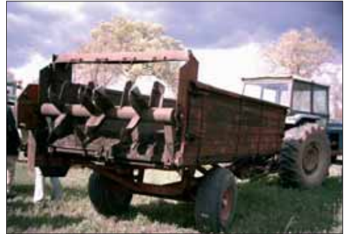
3.1: esparcimiento mecánico mediante un remolque esparcidor. Lo utilizaremos en grandes extensiones
