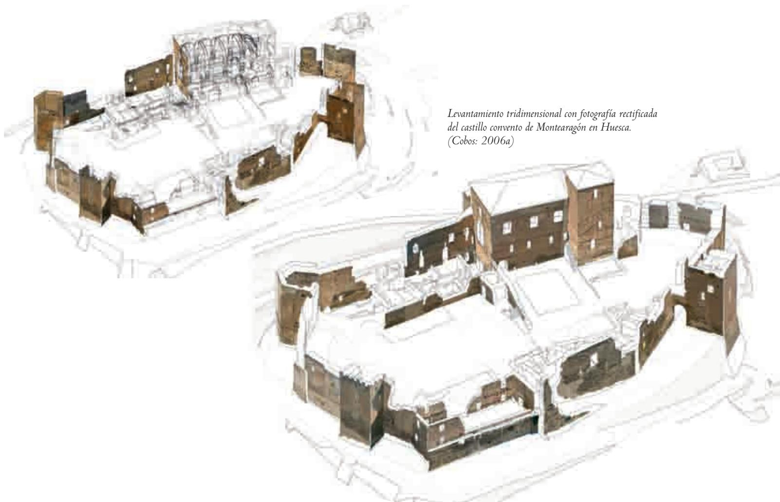
*Levantamiento tridimensional con fotografía rectificadas del castillo convento de Montearagón en Huesca. (Cobos: 2006a)*
