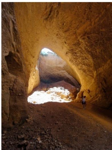
El sistema de explotación general empleado no difiere mucho en sus fundamentos del empleado en la actualidad para los mismos tipos de yacimientos auríferos. Equivale a lo que Estrabón denominó *crisoplisia* y Plinio describe en parte, refiriéndose en particular al sistema de explotación de cortas de minado, con el nombre de *arrvgiae* o *rvina montivm*. Consiste en emplear la fuerza hidráulica desde las zonas más altas para realizar las siguientes operaciones esenciales:
