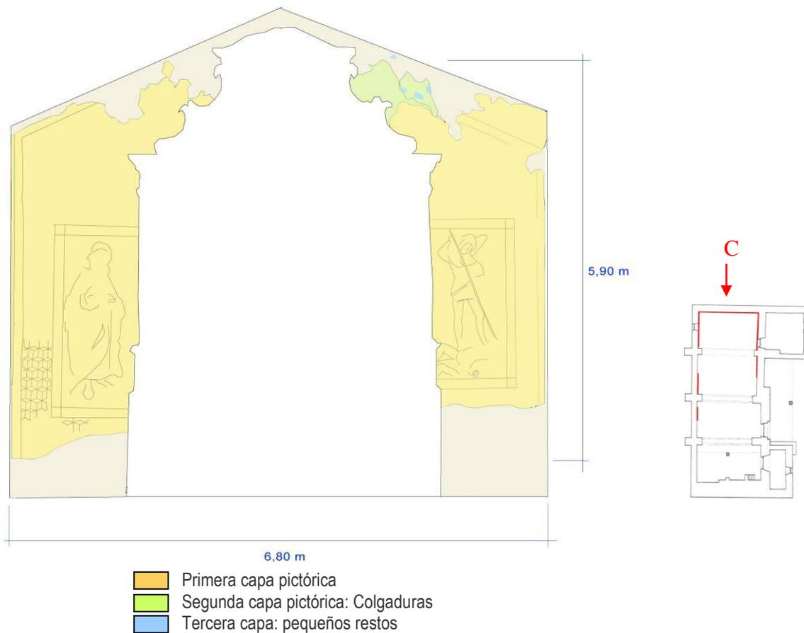
Fig. 18 - Esquema y dimensiones de las pinturas murales conservadas en el muro del testero.
