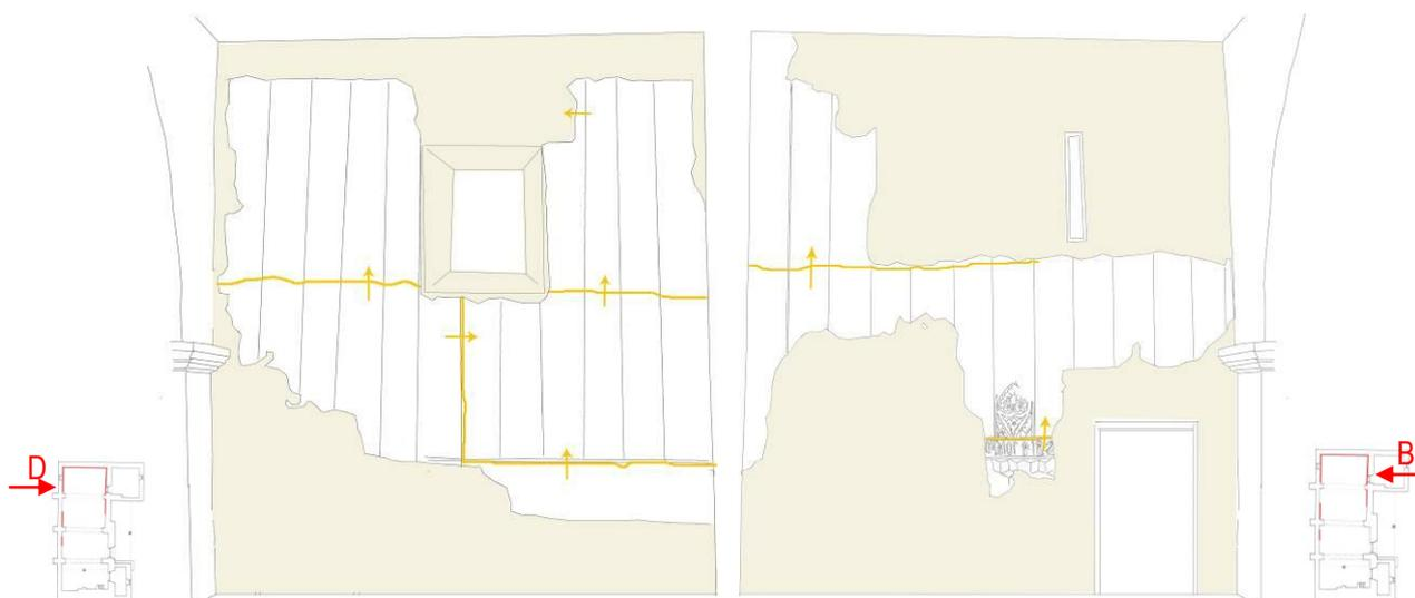
Fig. 16 - Esquema de las jornadas de ejecución. Las flechas amarillas indican la dirección en que una jornada se superpone a otra, lógicamente anterior. Como se aprecia en el muro D, se comenzó a trabajar por la parte superior y hacia abajo; y en la zona intermedia de derecha a izquierda.
