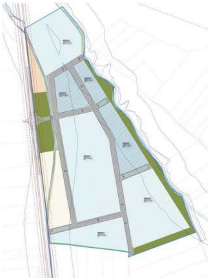
Figura 6: esquema de la Alternativa 3.a.2.b, con las dotaciones localizadas en una banda paralela a la carretera SG-313
