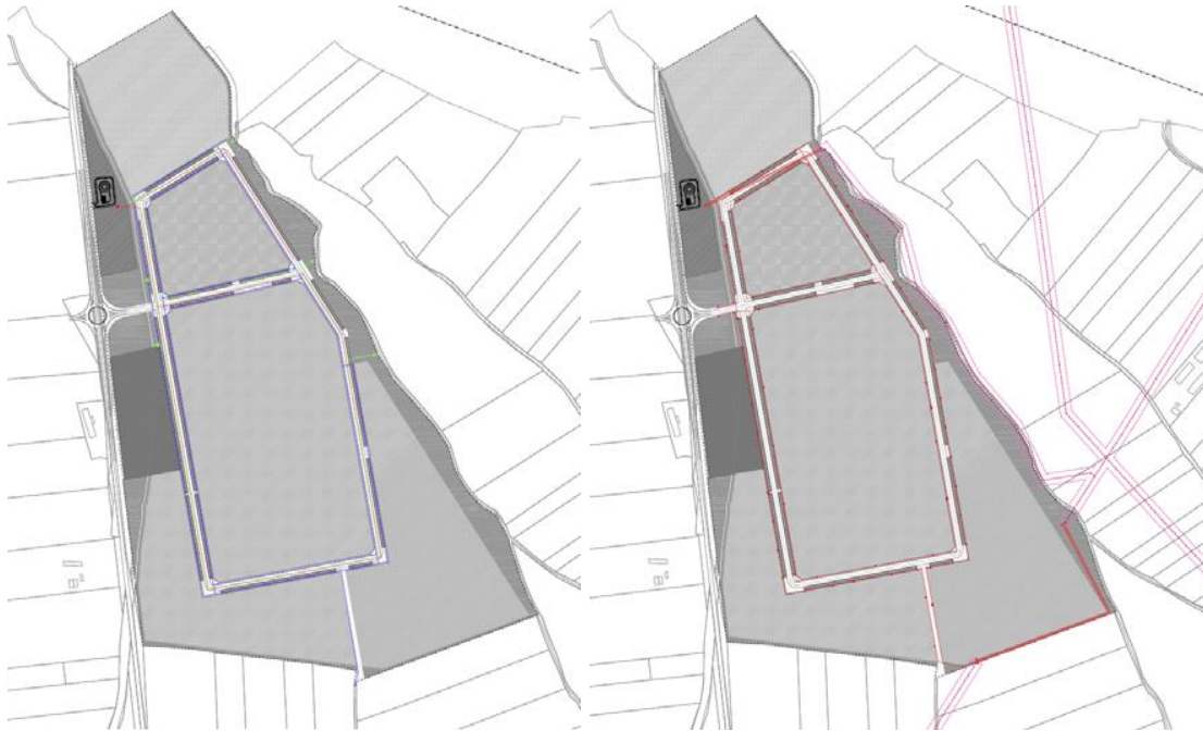
Figura 12: Redes de abastecimiento y saneamiento (izquierda) y de electricidad y alumbrado público (derecha)
